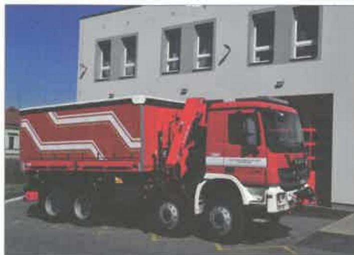
Auto je dále vybaveno hydraulickým navijákom o přímém tahu 6 800 kg umístěným v předním nárazníku. Pro převoz kontejnerů je na rámu vozidla umístěno natahovací zařízení o celkové natahovací síle 18 tun. Veškeré hydraulické zařízení je možné ovládat jak z vozidla, tak i pomocí dálkového rádiového ovládání. Natahovací zařízení pro převoz kontejnerů je kompatibilní s kontejnery HZS Libereckého kraje.
