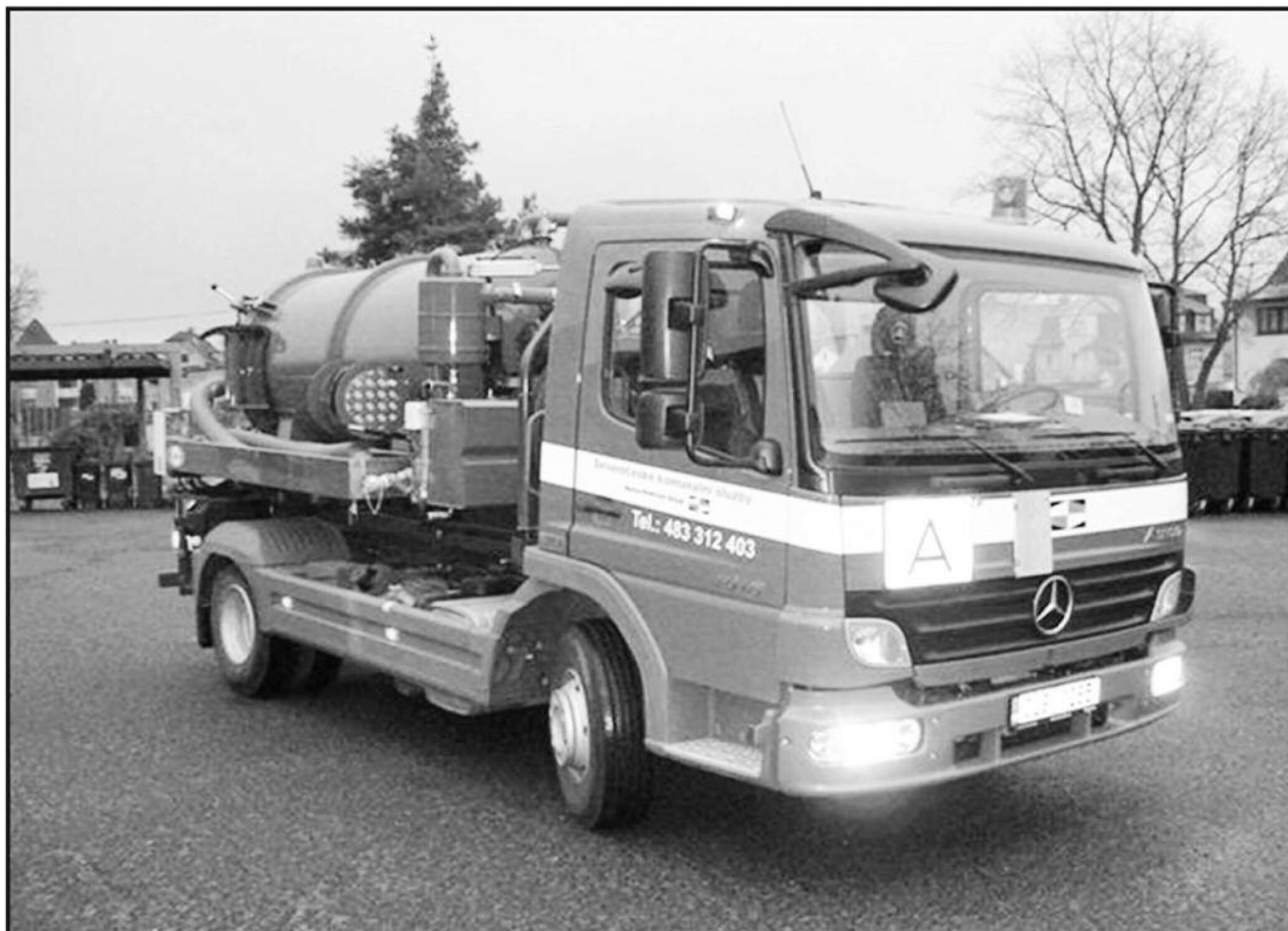
MERCEDES BENZ - ATEGO 1018 KK - hákový nosič nástaveb Výměnná fekální nástavba Fabok CAS 3,5. Rok výroby 02 /2011.
